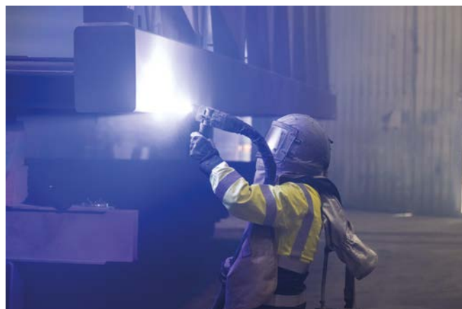
Bild 2 Thermisches Spritzen in der Anwendung Thermal spraying in practice
